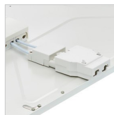
Der QuickConnector mit Steckanschlussklemme, zur Weiterverdrahtung geeignet, ermöglicht eine besonders einfache und schnelle Montage. Erst Kabel ohne Leuchte anschließen, dann Buchse und Stecker einfach zusammenklicken - fertig.
