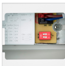
Der integrierte Lumen-Schalter (2 DipSwitches) ermöglicht die einfache Auswahl zwischen drei Leuchtenlichtströmen
